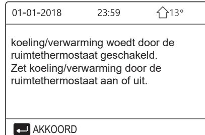
② De kamerthermostaat is IN ÉÉN ZONE OF DUBBELE ZONE INGESTELD (zie "KAMER THERMOSTAAT INSTELLEN" in "Installatie- en gebruikershandleiding"). De kamerthermostaat regelt de unit AAN / UIT, de werkingsmodus wordt ingesteld op de HMI-interface.
